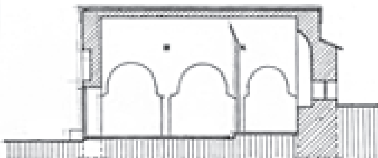
Надолжен пресек / Longitudinal section
